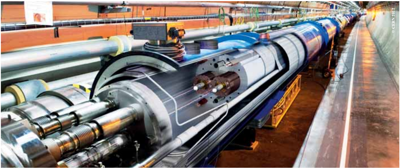
▲ Vue 3D d'un des 400 aimants quadripôles du LHC, dans lequel circulent en sens inverse deux faisceaux de protons.
