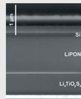
Fig. 1 SEM/FIB cross section of a Li x TiO y S z /LiPON/Si Li-ion cell
