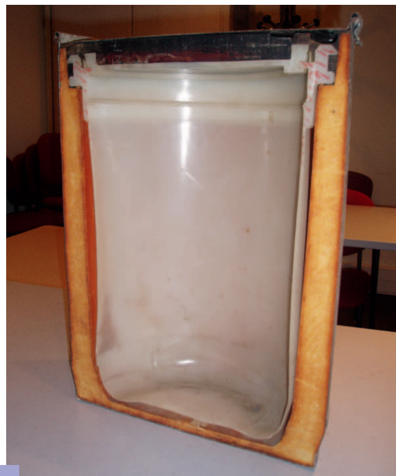
Présentation en coupe d'une poubelle La Calhène® (PLC) insérée dans un fût de 50L. La PLC est un récipient en polyéthylène de 22 litres environ permettant de recueillir les substances radioactives contenues dans les boîtes à gants ou les cellules blindées en cours d'assainissement sans rupture de confinement.
