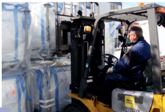
Les «big bags» sont utilisés pour conditionner et transporter des déchets TFA (Très faiblement actifs). © CEA
